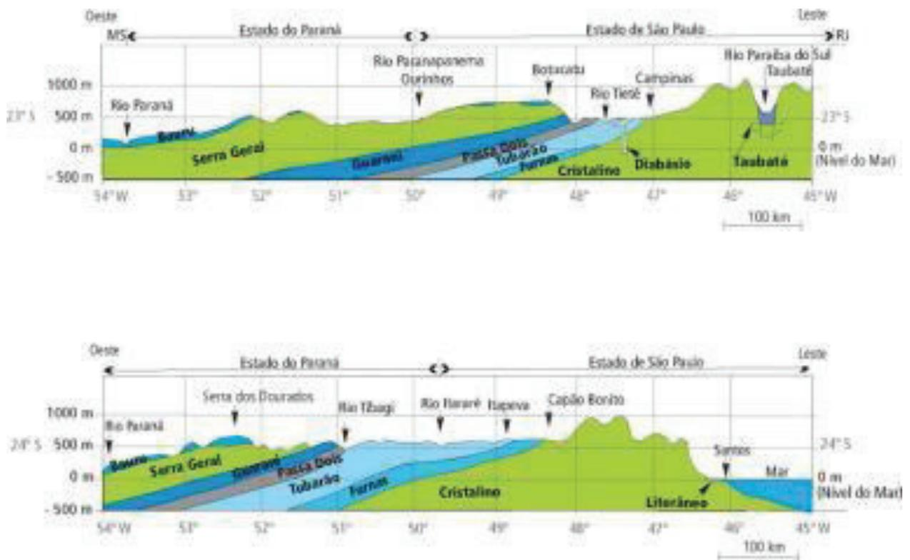
Figura 7- Seção hidrogeológica esquemática do Estado de São Paulo
