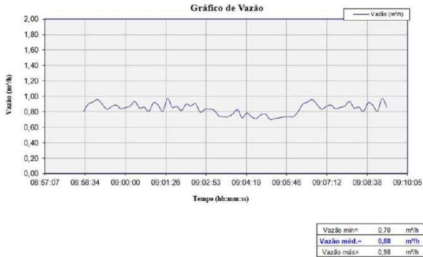
Figura 3-53. Gráfico de vazão (Medição 12).
