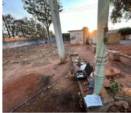
Figura 3-75. Medição de Vazão – Reservatório Elevado Progresso.
