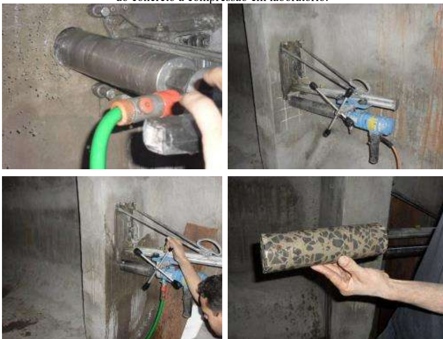
Figura 4-437 - Vistas do ensaio de extração de testemunhos para ensaios de resistência do concreto a compressão em laboratório.
