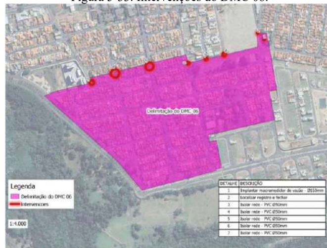
Figura 5-33. Intervenções do DMC 06.
