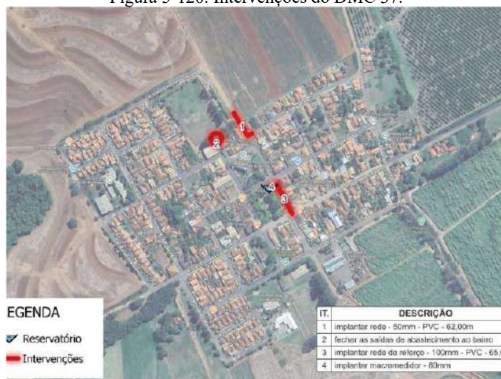
Figura 5-120. Intervenções do DMC 37.
