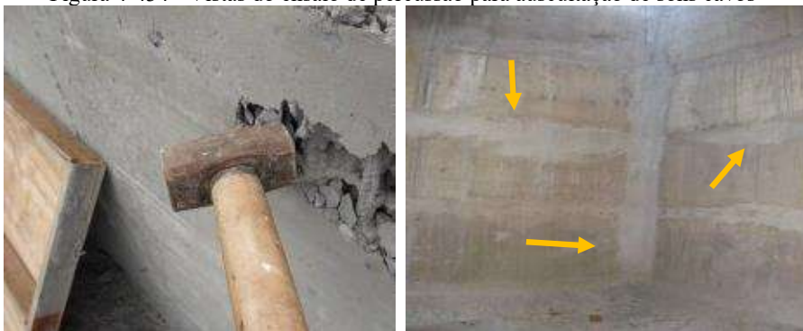
Figura 4-435 - Vistas do ensaio de alcalinidade do concreto
