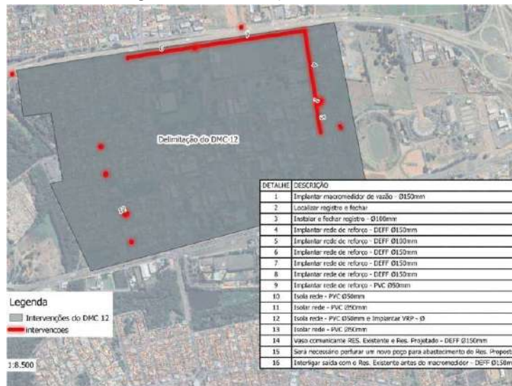
Figura 5-62. Intervenções do DMC 12.
