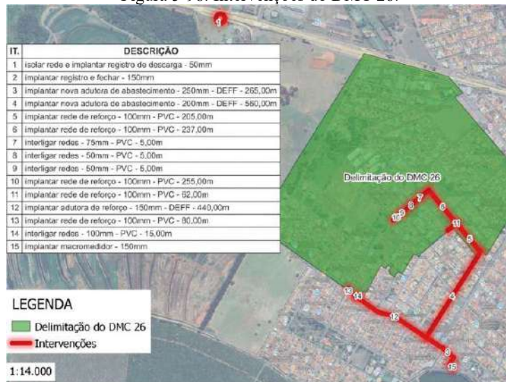
Figura 5-98. Intervenções do DMC 26.
