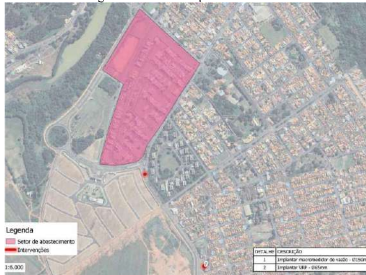
Figura 5-11. Intervenções do DMC 02.
