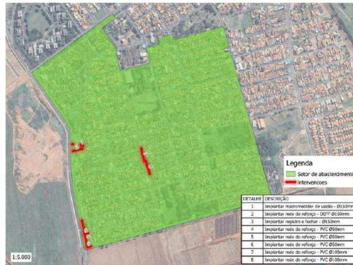
Figura 5-8. Intervenções do DMC 01.
