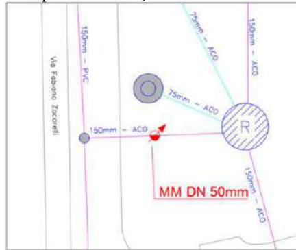
Figura 6-2. Croqui de localização do macromedidor do DMC 02
