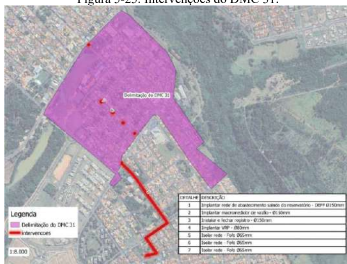
Figura 5-25. Intervenções do DMC 31.
