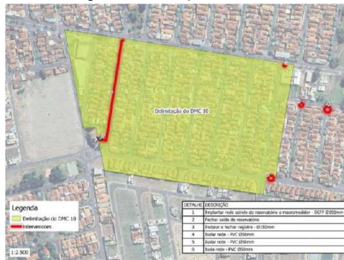
Figura 5-36. Intervenções do DMC 10.
