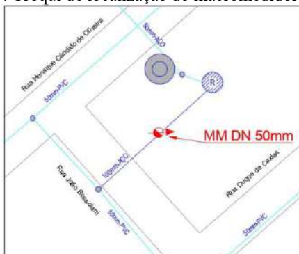
Figura 6-33. Croqui de localização do macromedidor do DMC 38
