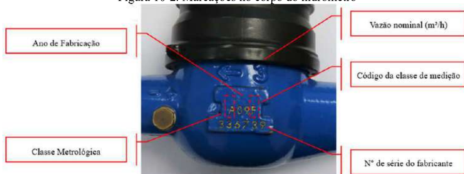
Figura 10-2. Marcações no corpo do hidrômetro
