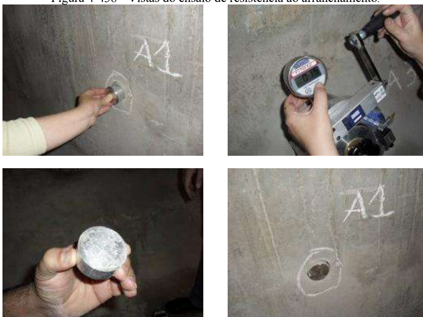
Figura 4-438 - Vistas do ensaio de resistência ao arranchamento.
