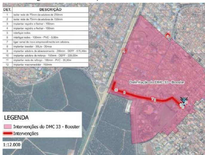
Figura 5-44. Intervenções do DMC 33 - Booster.
