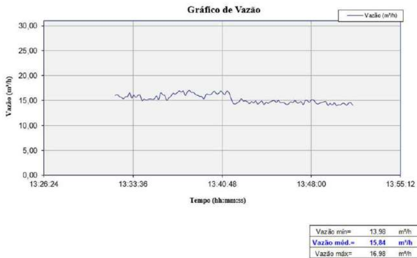
Figura 3-105. Gráfico de vazão (Medição 25).
