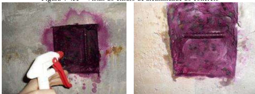
Figura 4-435 - Vistas do ensaio de alcalinidade do concreto
